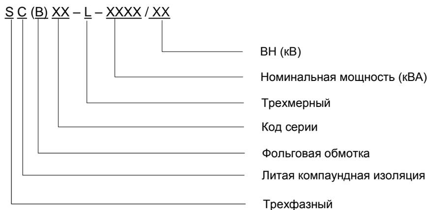
ВН — напряжение обмотки высокого напряжения
