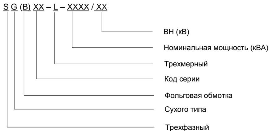
ВН — напряжение обмотки высокого напряжения
